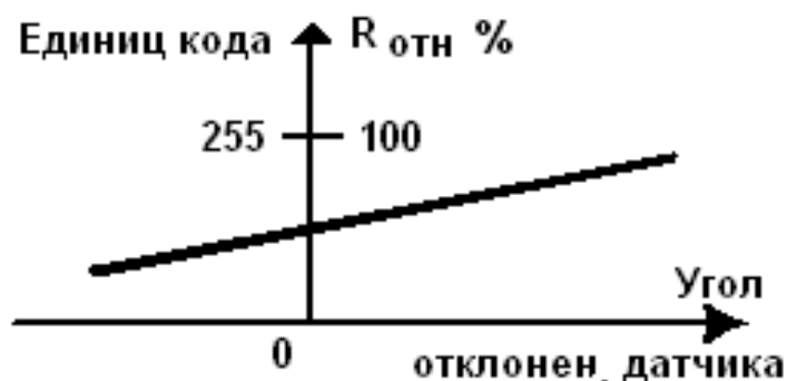
Рис. 3.9. Вид тарировочных графиков датчиков МУ-615
