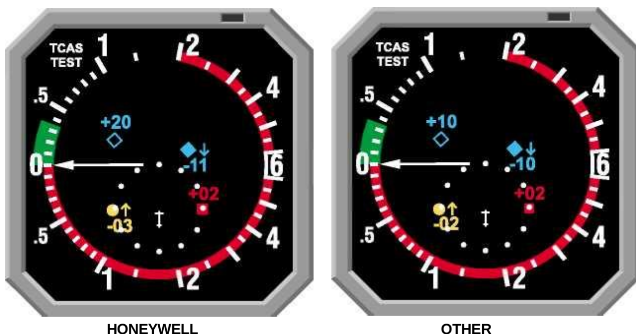
Рис. 1.49. Тестовое изображение воздушной обстановки на дисплее фирм различных производителей
